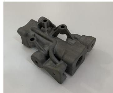
*Gain de masse de 25 % sur un bloc de régulation hydraulique de Safran Landing System*
