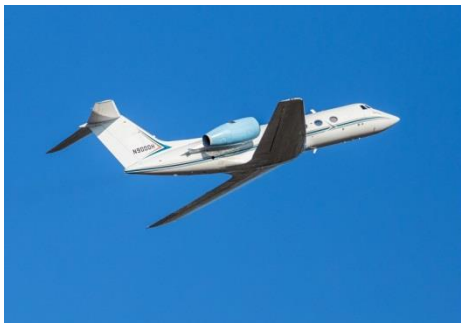
Essais en vol du Silvercrest sur banc d'essais volant
