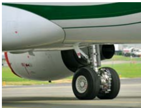
2 - L'egts : système électrique de roulage au sol.
