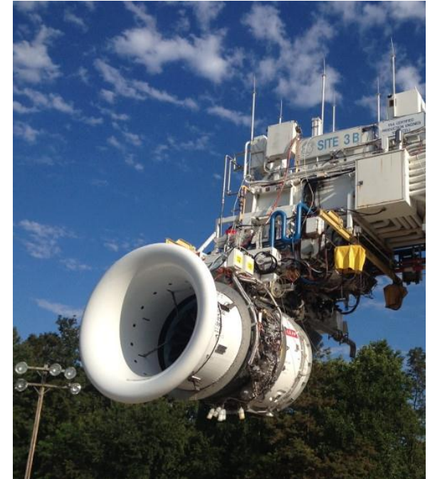
Le moteur LEAP-1A a débuté ses essais au sol le 4 septembre 2013
