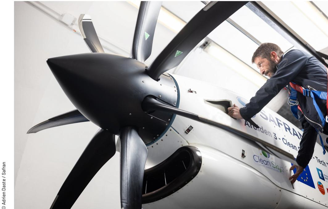
Safran Helicopter Engines a testé au sol une variante "plus électrique" de son turbopropulseur Tech TP, sur son site de Tarnos. Ce démonstrateur technologique, basé sur l'Ardiden 3, a été équipé de technologies issues du projet ACHIEVE de Clean Sky<sup>1</sup>, permettant des modes de fonctionnement plus efficaces et plus durables.
