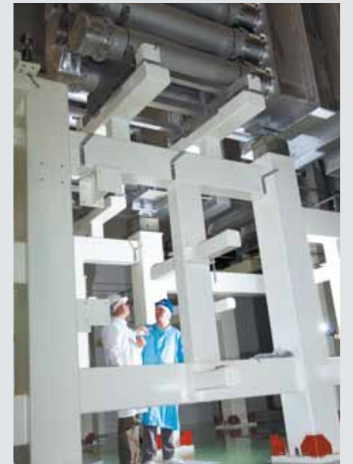
Supports des modules de pré-amplification du laser Megajoule du CEA, utilisé pour recréer les conditions de la fusion nucléaire. Sagem est impliqué dans ce programme.
