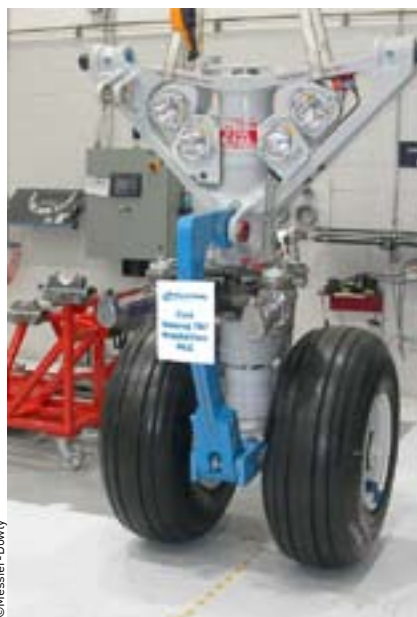
Premier train d'atterrissage produit par Messier-Dowty pour le 787.
