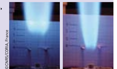
Illustration de l'effet du plasma sur la stabilisation des flammes. À gauche : aucun plasma n'est appliqué et la flamme est proche de l'extinction. À droite : l'application du plasma permet une parfaite stabilité de la flamme.
